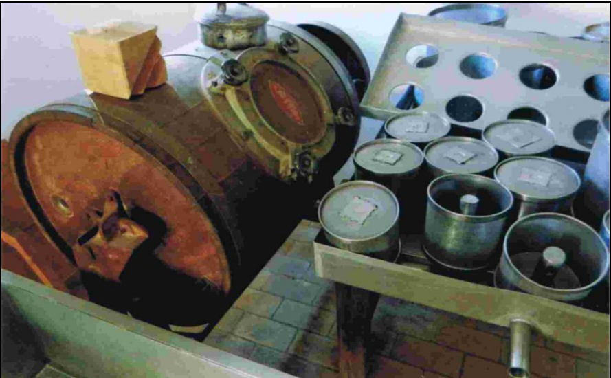
Mit dem Pferdegöpel wurde ein Butterfaß in Bewegung gesetzt. Nach Einführung der Dampfkraft konnte man auf einen Göpel verzichten.
