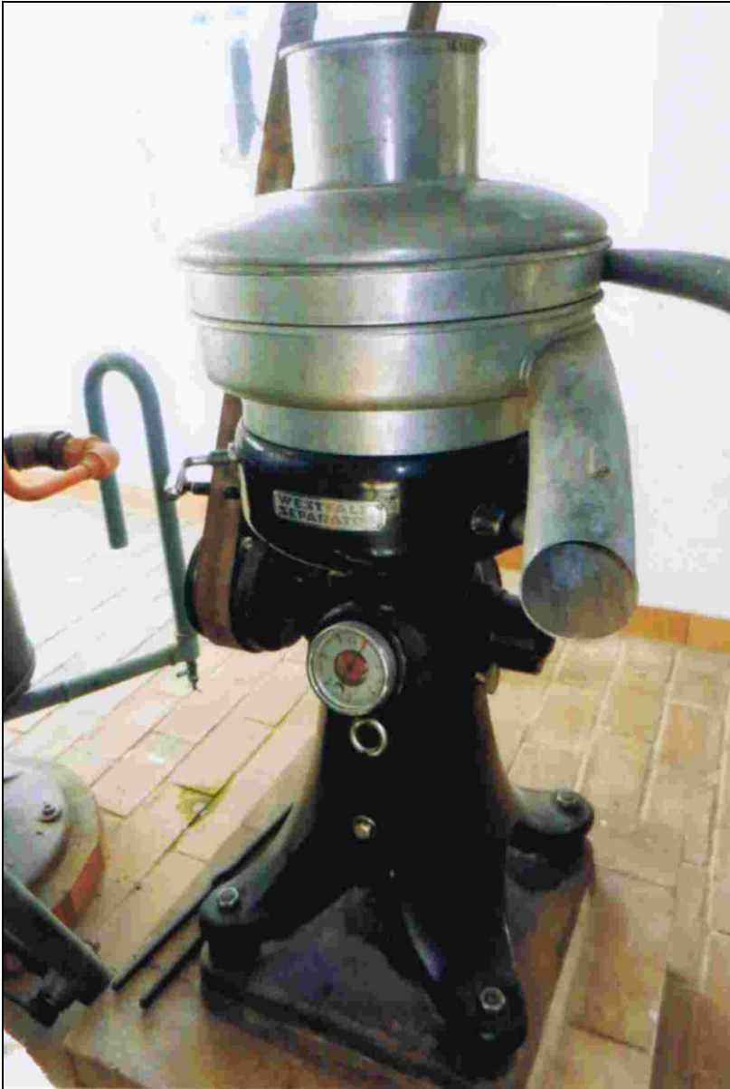
Die Milch-Zentrifuge oder Separator von der Firma Westfalia. Ausscheidung von Rahm und Magermilch war das Ergebnis.
